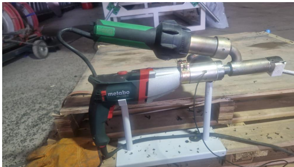
4-сурет – Қолдық дәнекерлеу экструдері
